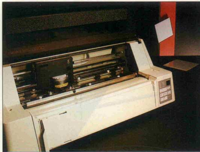
Der Juki 7200 bedruckt das Papier nicht auf einer Walze, sondern auf einer planen Fläche.
